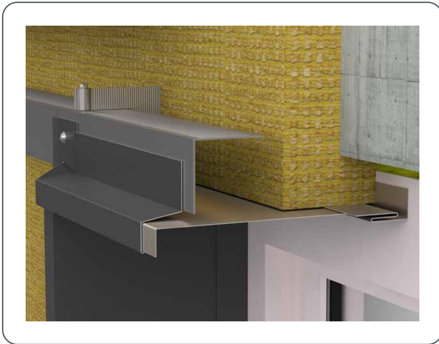
Ilustracija 101 • Montaža okapnog lima natprozornika
