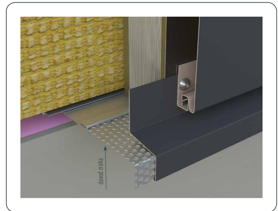
Ilustracija 70 • Početni profil za horizontalno polaganje
