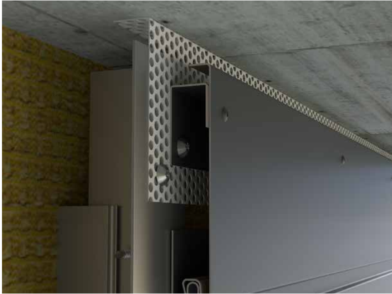
Ilustracija 87 • Gornji završetak horizontalne fasadne kazete
