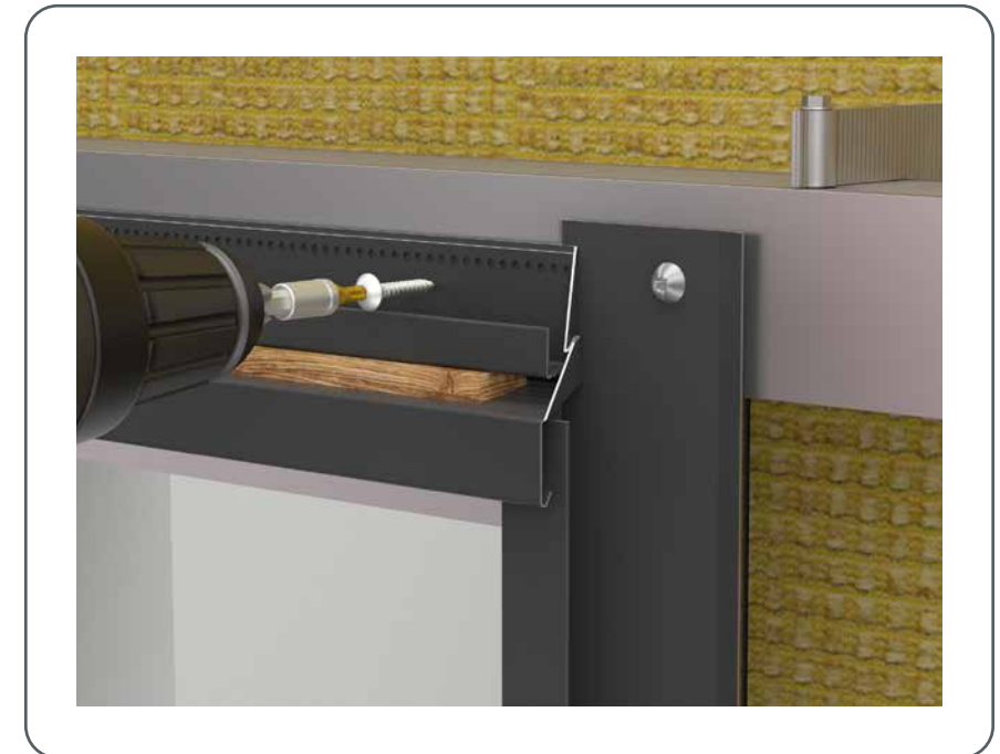
Ilustracija 102 • Montaža perforirane blende na okvir prozora
