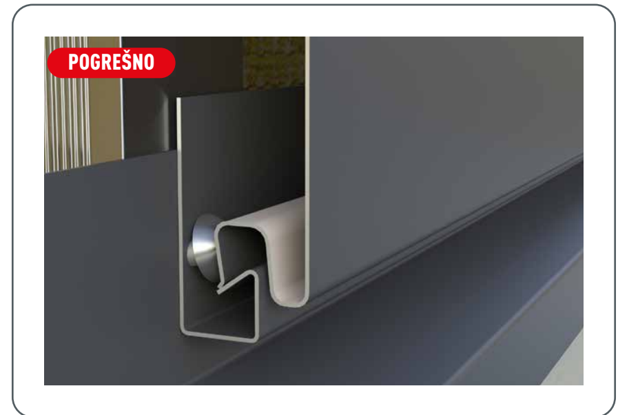
Ilustracija 77 • Neadekvatno pričvršćivanje početnog profila
