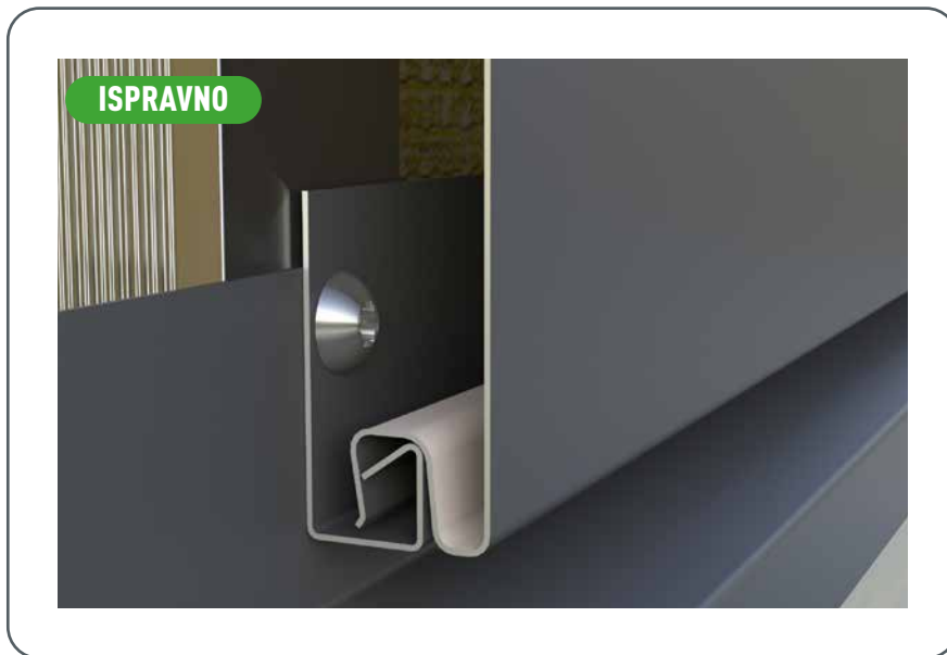
Ilustracija 76 • Adekvatno pričvršćivanje početnog profila
