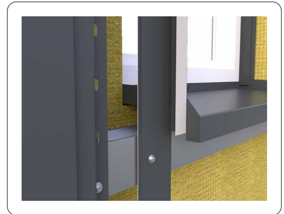
Ilustracija 96 • Montaža kutne pregrade na prozorski otvor
