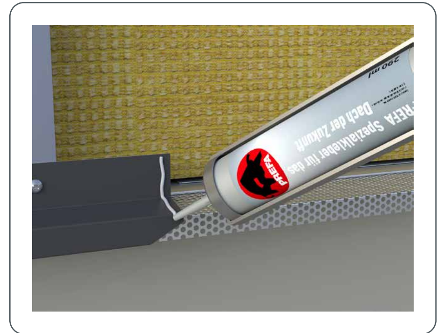
Ilustracija 68 • Spoj okapnih limova
