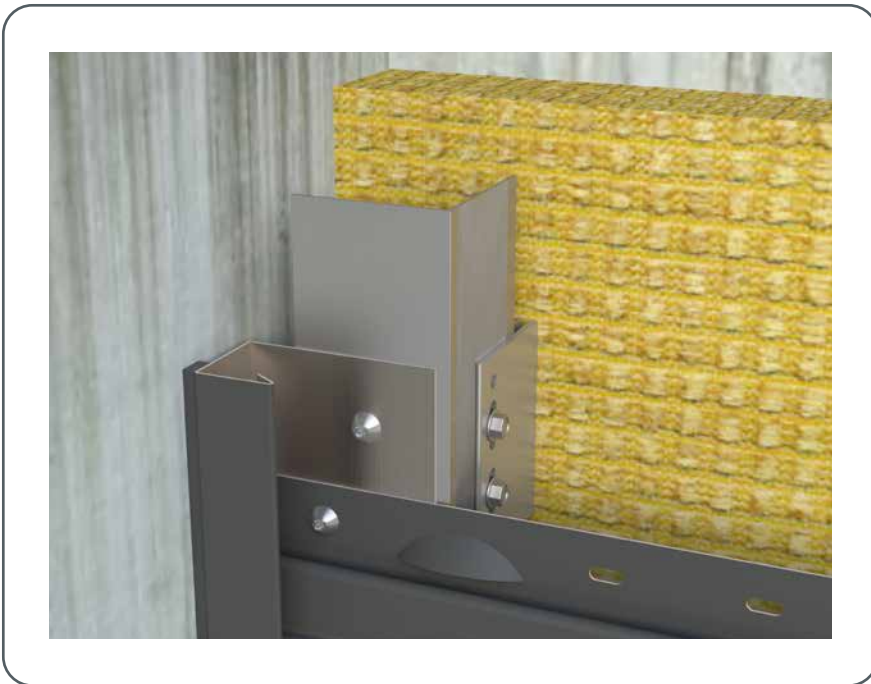
Ilustracija 85 • Bočni spoj
