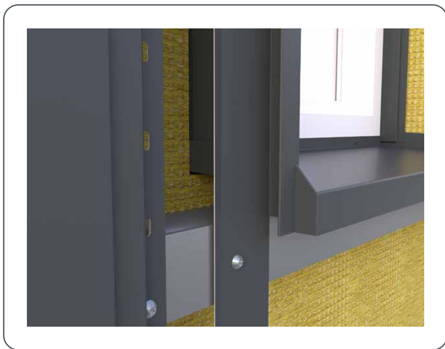
Ilustracija 99 • Montaža prozorskog otvora
