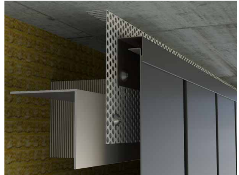
Ilustracija 88 • Gornji završetak vertikalne fasadne kazete
